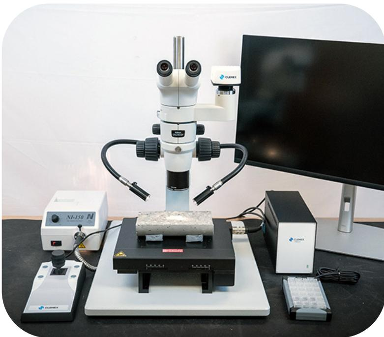
L'analyse de la proportion et de la répartition des vides d'air dans le béton durci est un élément clé de l'évaluation de la résistance du béton aux cycles de gel et de dégel.
